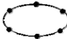
**Кольцевая сеть.** Сеть, в которой к каждому узлу присоединены две и только две ветви.
