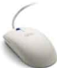
**Мышь** имеет вид небольшой коробки, полностью уместяющейся на ладони. Мышь связана с компьютером кабелем через специальный блок — адаптер, и её движения преобразуются в соответствующие перемещения курсора по экрану дисплея. В верхней части устройства расположены управляющие кнопки (обычно их три), позволяющие задавать начало и конец движения, осуществлять выбор меню и т.п.
