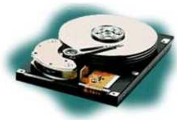
Рис. 2.8. Винчестерский накопитель со снятой крышкой корпуса
