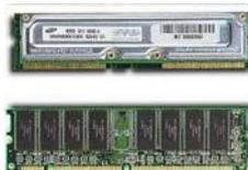
Рис. 2.6. Микросхемы памяти RIMM (сверху) и DIMM (снизу)
