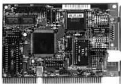
Рис. 2.30. Сетевой интерфейсный адаптер
