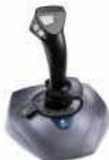
**Джойстик** — обычно это стержень-ручка, отклонение которой от вертикального положения приводит к передвижению курсора в соответствующем направлении по экрану монитора. Часто применяется в компьютерных играх. В некоторых моделях в джойстик монтируется датчик давления. В этом случае, чем сильнее пользователь нажимает на ручку, тем быстрее движется курсор по экрану дисплея.
