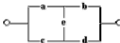
**Решение.** Имеется четыре возможных пути прохождения тока при замкнутых переключателях a, b, c, d, e : через переключатели a, b; через переключатели a, e, d; через переключатели c, d и через переключатели c, e, b. Функция проводимости  $F(a, b, c, d, e) = a \cdot b \vee a \cdot e \cdot d \vee c \cdot d \vee c \cdot e \cdot b$ .
