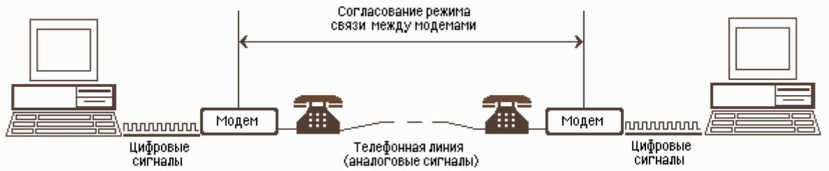
Рис. 2.24. Схема реализации модемной связи
