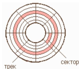
Рис. 2.7. Поверхность магнитного диска
